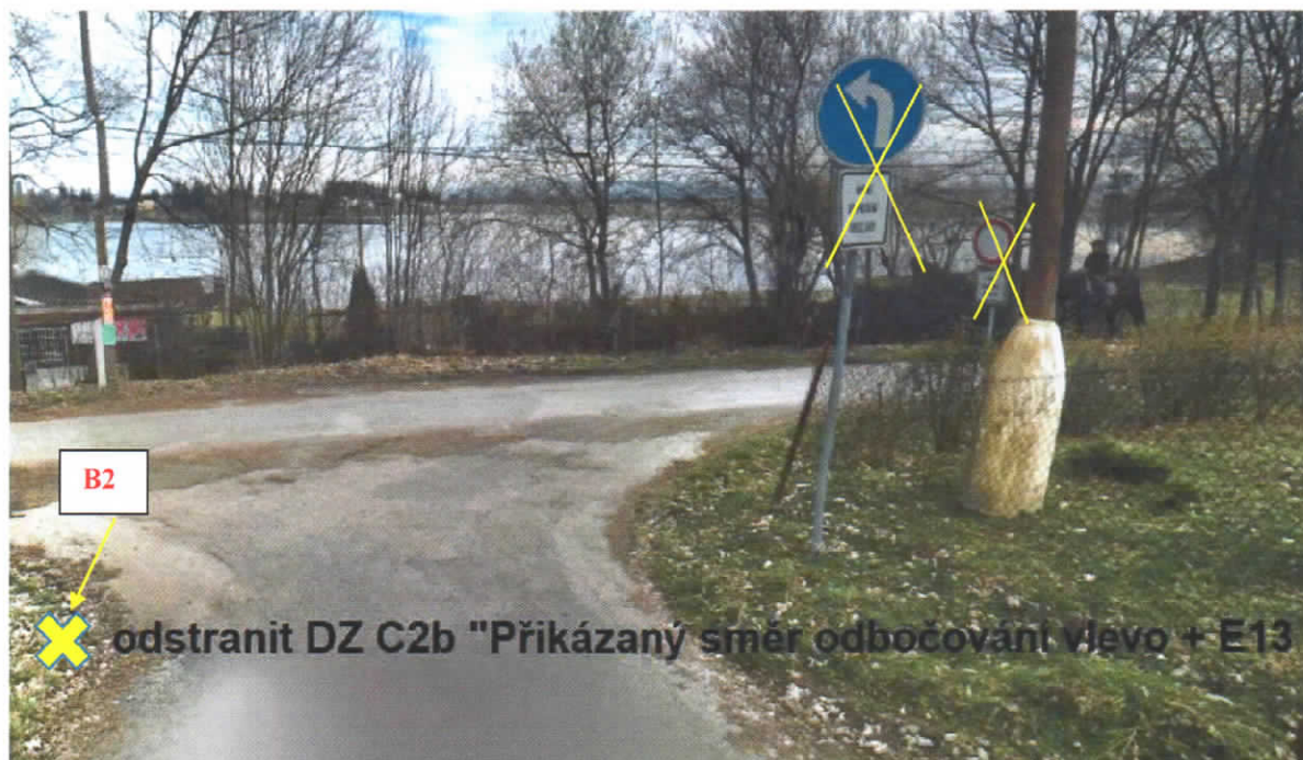
Foto č. 9 – odstranění DZ B1 (zákaz vjezdu) + E13 (text), C2b (přikázaný směr odbočování vlevo + E13 (text) a vrátit DZ B2 (Zákaz vjezdu všech vozidel)
