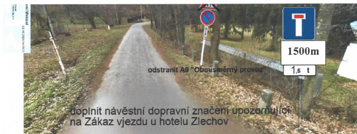
Foto č. 10 – DZ A9 „Obousměrný provoz“ je nadbytečná dopravní značka a je možné ji odstranit. Dále budou doplněny značky IP4a (slepá komunikace) + E3a (vzdálenost)1500m + E5 (největší povolená hmotnost) 1,5t
