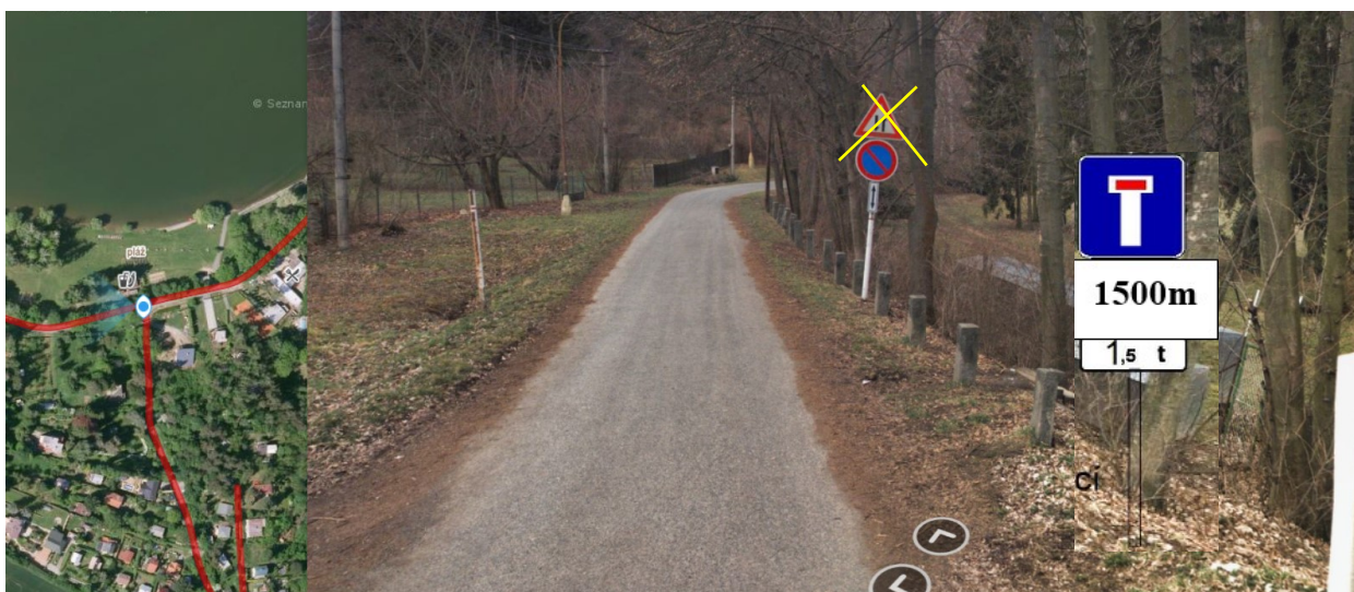
Foto č. 10 – Dopravní značka A9 „Obousměrný provoz“ je nadbytečná dopravní značka a je možné ji odstranit. Dále budou doplněny značky IP4a (slepá komunikace) + E3a (vzdálenost) 1500m + E5 (největší povolená hmotnost) 1,5t
