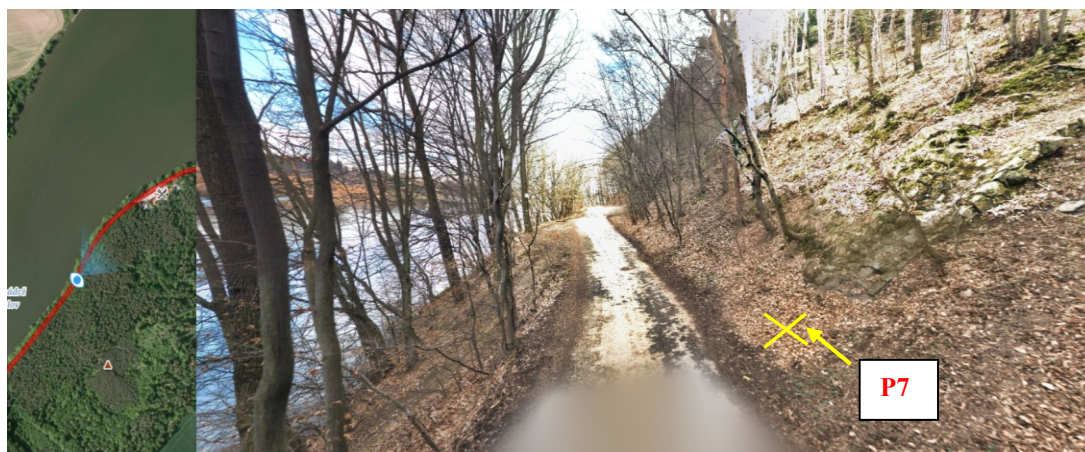
Foto č. 7 – před lomem ve směru od Plumlova do Zlechova umístit dopravní značku P7 (přednost protijedoucích vozidel)
