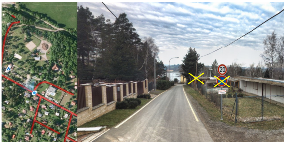
Foto č. 3 – u kempu nad přehradou v Mostkovicích budo odstraněny svislé dopravní značky 2x B29 „Zákaz stání“ a ponechá se pouze vodorovná dopravní značka V12c „Zákaz zastavení“.
