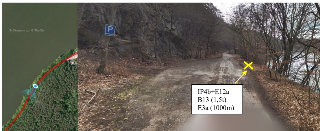
Foto č. 6 – u lomu ve směru od Zlechova do Plumlova – nově umístit pod sebe IP4b (jednosměrka) + E12a (jízda cyklistů v protisměru), B13 (s vyznačením 1,5t) a E3a (1000m)
